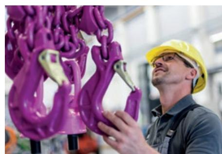
**Attenzione!** Se siete voi stessi a comporre le imbracature, dovete utilizzare soltanto le catene di sollevamento! L'uso di catene di ancoraggio non è consentito per effettuare operazioni di sollevamento, ciò perché hanno un fattore di sicurezza diverso ed inferiore rispetto a quello delle catene di sollevamento.
