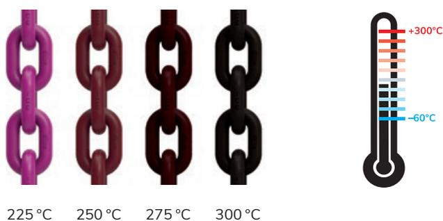
In caso di temperature di utilizzo estreme, anche la verniciatura a polveri rosa fluorescente della catena VIP cambia colore in modo permanente oltre i 200 °C. Se la temperatura aumenta ancora eccessivamente superando i 380 °C, il colore diventa nero intenso e si formano delle piccole bolle. In tal caso occorre sostituire la catena VIP.
